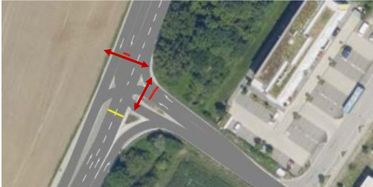
Abbildung 10: Grober Entwurf signalisierter Knotenausbau B301/ Dornierstraße (Obermeyer, 2025) mit zusätzlichen Querungsmöglichkeiten (Furten)
